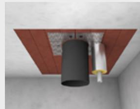
Rohrisolierungen aus Mineralwolle dürfen bis auf 10 mm an das brennbare Rohr herangeführt werden und das Streckgitter überdecken.
