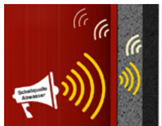
Schallreflexion an Schwererschicht der Dämmung
