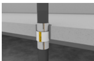
Weiterführende Schalldämmung MSA 9
