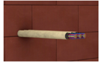
Leitungen aus Stahl- oder Kunststoffrohren für Steuerungszwecke bis zu einem maximalen Außendurchmesser von 15 mm.
