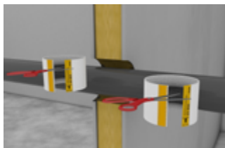
Anlegen der BSM-KR: Bei dünnen Wänden (100–170 mm) beide Brandschutz-Dämm-Manschetten oberhalb des Blähmaterials kürzen.
