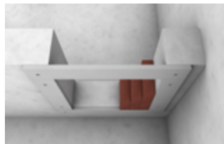
Aufleistung für Massivdecke
