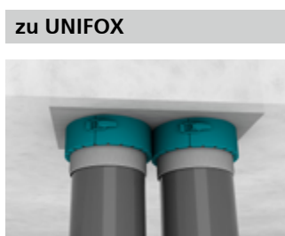
0 mm Die Rohrmanschetten dürfen aneinander grenzen. Alle Zwickel zwischen den Manschetten müssen dicht verschlossen werden.
