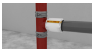
Übergang Guss-Kunststoff-Abwasserleitungen frei im Raum
