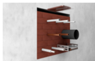
Verschluss Restöffnung oberste Schottreihe
