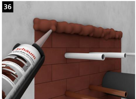
Im oberen Bereich darf die Fuge zwischen KaRo-Steinen und Bauteilaibung in einer max. Höhe von 60 mm auf der Gesamtbreite des KaRo-Schotts mit KaRo-Schaum verfüllt werden.
