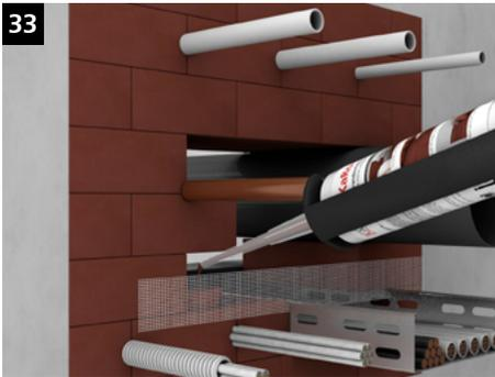
Zur leichteren Montage kann das KaRo-Montagehilfsband (Schalungsband) verwendet werden.
