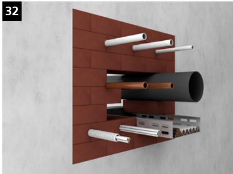
Teilbereiche zwischen Installationen sowie zwischen Installationen und der Bauteilöffnungs-laibung können bis zu einer Größe von max. 450 x 500 mm (Breite x Höhe) mit KaRo-Schaum, vollständig in Mindestschottdicke von 200 mm, verfüllt werden.
