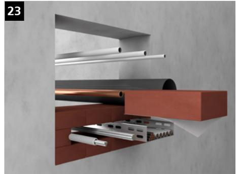
Entfernen Sie die Schutzfolie der KaRo-Steine und bauen Sie diese längs (Schottdicke 200 mm) im Mauerverband (Versatz der vertikalen Steinfugen) strammsitzend in der Bauteilöffnung ein.
