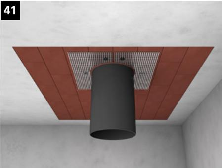
Es sind mindestens drei Schrauben je Hälfte bzw. sechs Schrauben insgesamt zu verwenden. Die Schrauben werden in einem Abstand von ca. 25 mm zum Rohr montiert.
