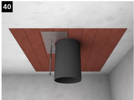
Das Streckgitter wird mit Allzweckschrauben (Grobgewinde)  $D \geq M6$ ,  $L \geq 150 \text{ mm}$  an den KaRo-Steinen verschraubt.
