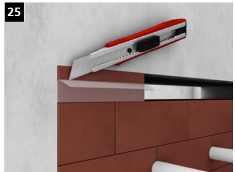
Enge Restöffnungen ( $\leq 60$  mm) können mit dem vakuumierten KaRo-Stein verschlossen werden. Dafür legen Sie die vakuumierten KaRo-Steine ungeöffnet in die Öffnung. Nach Aufschneiden der Folien expandieren die vakuumierten KaRo-Steine auf die Standardgröße. Die Folie kann innerhalb der Abschtutung verbleiben, sie muss jedoch beidseitig bündig zur Schottoberfläche entfernt werden.
