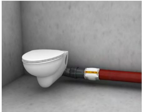
Mischinstallation mit Anschlussleitung Wand-WC.
