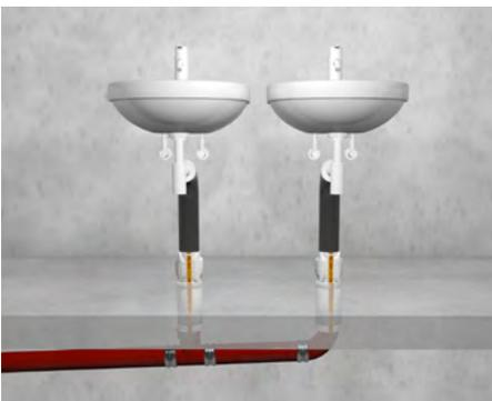
Materialwechsel bei zwei Anschlussleitungen.
