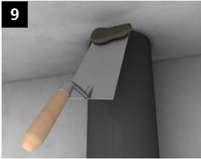
9 Öffnung mit mineralischem Mörtel verschließen.\*
