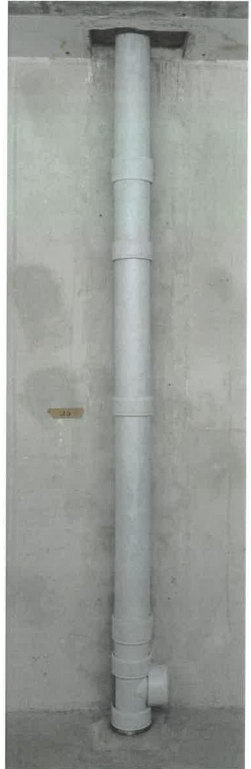
Bild links oben: Prüfaufbau im unteren Wandbereich mit Rohrummantelung, Rohrschelle unter der Rohrummantelung, mit Schallentkoppler und Brandschutzmanschette "BSM-KR" im Deckendurchbruch.
