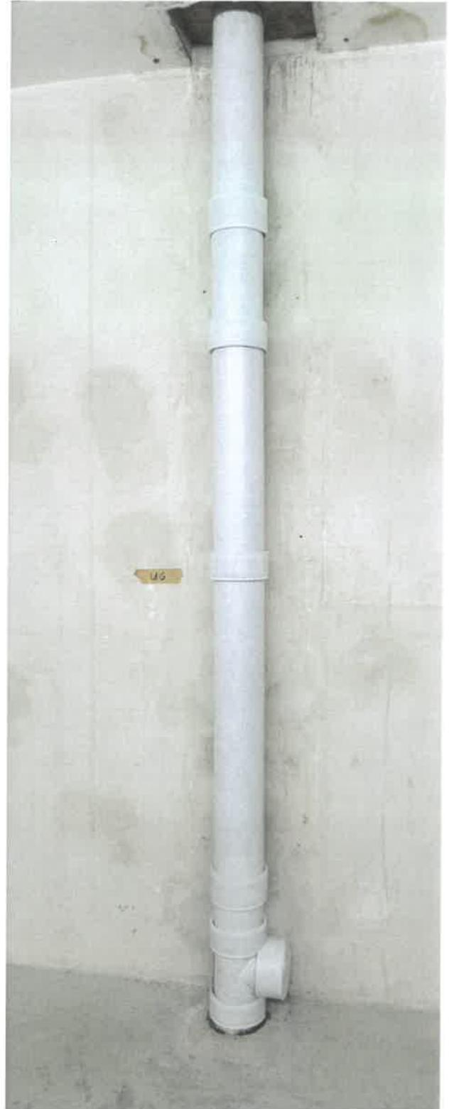
Bild links oben: Referenzaufbau ohne Rohrummantelung, Rohrschelle mit Schallentkoppler im oberen Wandbereich.
