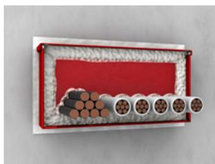
Kabelbelegung mit Schallschutzkissen
