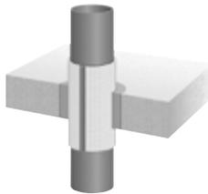
in Massivdecke mit Formteilen:
