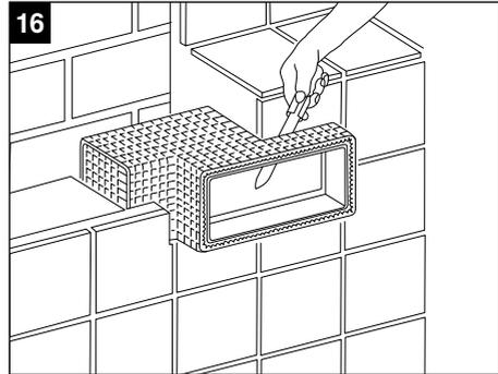
Nach dem Verfliesen Dämmkragen des Bauschutzes bündig mit Fertigwand abschneiden.
