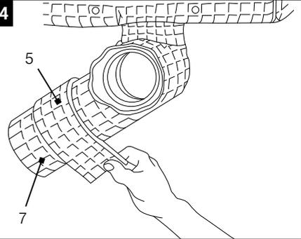
Schlauchstück DN 100 (7) montieren mit Verschlussband (5) abkleben.
