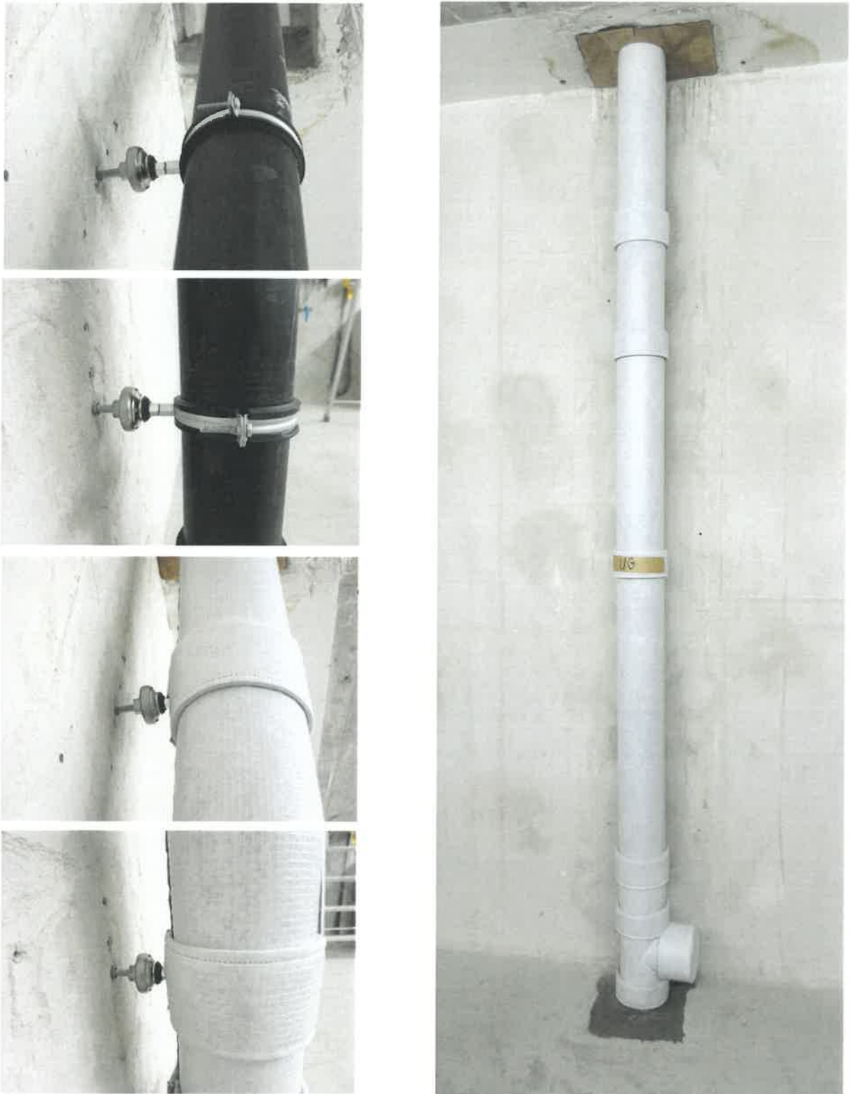
Bild links oben: Referenzaufbau ohne Rohrummantelung, Rohrschelle mit Schallentkoppler im oberen Wandbereich. Bild links Mitte oben: Referenzaufbau ohne Rohrummantelung, Rohrschelle mit Schallentkoppler im unteren Wandbereich. Bild links Mitte unten: Prüfaufbau mit Rohrummantelung, Rohrschelle mit Schallentkoppler im oberen Wandbereich. Bild links unten: Prüfaufbau mit Rohrummantelung, Rohrschelle mit Schallentkoppler im unteren Wandbereich. Bild rechts: Prüfaufbau Abwassersystem mit "Missel MSA-KLW" ummantelt und im Deckendurchbruch mit Mörtel vergossen.
